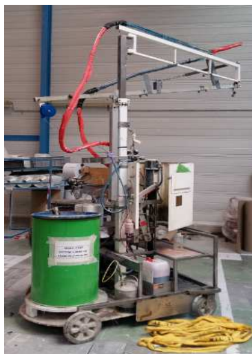
Remise en état des bras de projection - SPBI
